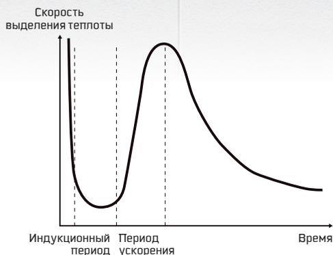
*Рис. 3.8. Выделение теплоты при гидратации портландцемента*
